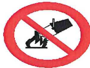
VIETATO SPEGNERE CON ACQUA
