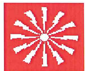
PULSANTE DI ALLARME ANTINCENDIO
